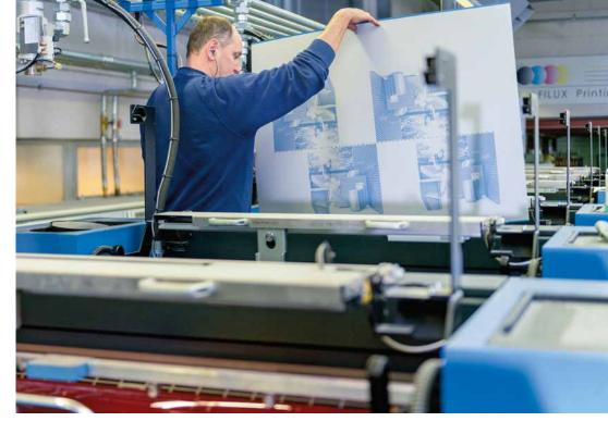
Arriba: Los cambiadores de planchas (DriveTronic SPC) trabajan con planchas de impresión no encorvadas
