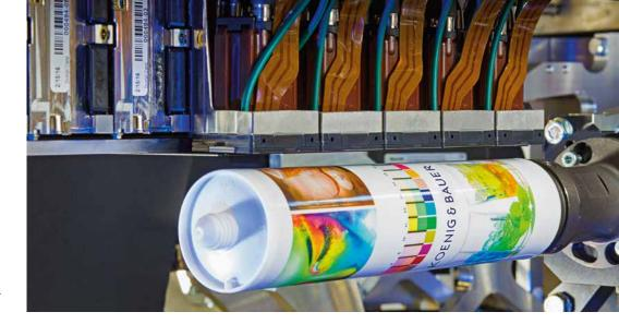
Impresión de inyección de tinta digital en un cartucho de lubricante
