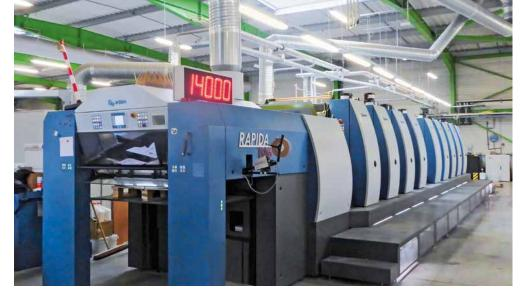
Izda.: Una de las Rapida 106: gracias al paquete High Speed, produce con hasta 18.000 pliegos/h
