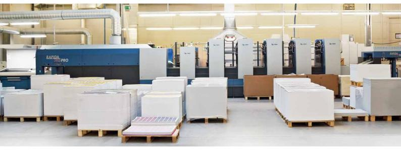
El corazón de la sala de impresión: la nueva Rapida 105 PRO de cinco colores con torre de laca y prolongación de la salida
