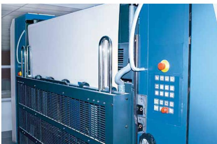
Los equipos totalmente automáticos de cambio de planchas FAPC permiten un rápido cambio de pedido
