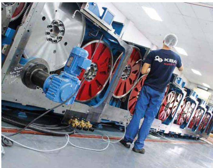
Tras el montaje de los cajones de la subestructura, empieza la colocación de los cuerpos de impresión
