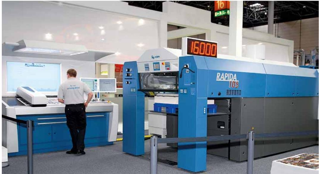
El puesto de mando altamente moderno ErgoTronic de la Rapida 105 con técnica de medición integrada
