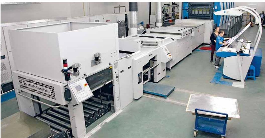
La foto muestra la línea instalada en 2012: una MetalStar PR UV de 6 colores con SMS y apiladora de alta velocidad
