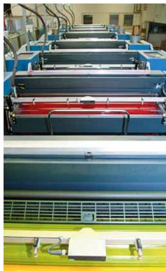
**Dos veces cuatro colores y lacado por un lado es lo que ofrece Werbedruck Aug. Lönneker con solo una máquina offset de pliegos de máxima flexibilidad**
