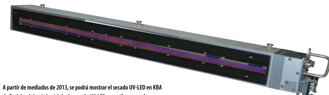
A partir de mediados de 2013, se podrá mostrar el secado UV-LED en KBA de Radebeul. Aquí el módulo de secado UV-LED para ello necesario
