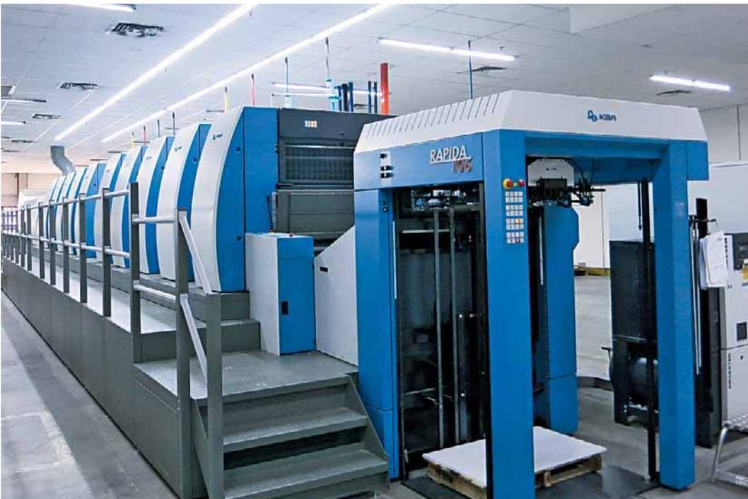
La nueva máquina de retirada de diez colores KBA Rapida 106 es la segunda instalación de KBA en poco tiempo en la planta de TWP en Johor Bahru
