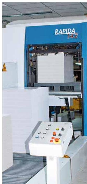
Un elemento destacado de la Rapida 142 de TWP es la logística de pilas totalmente automática; aquí en el marcador
