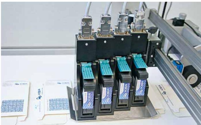
Se pueden conectar en cascada hasta 4 cabezales, lo que equivale a anchos de impresión de hasta 2" (50,8 mm)
