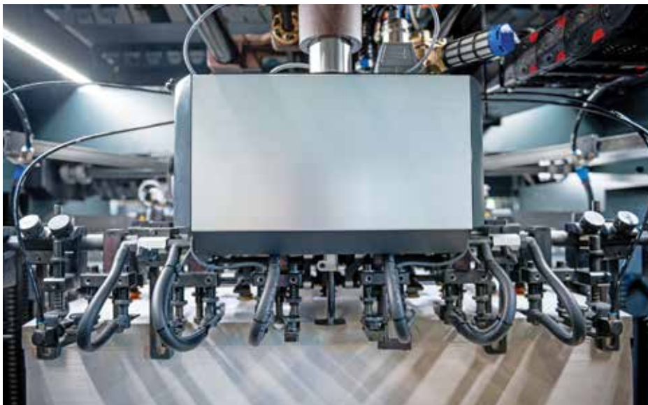
Stejně jako zde na nakládací hlavě nakladače nelze na celém stroji najít skoro žádné ovládací prvky. Téměř všechny procesy lze řídit pomocí dotykových displejů nebo ovládacího pultu.
