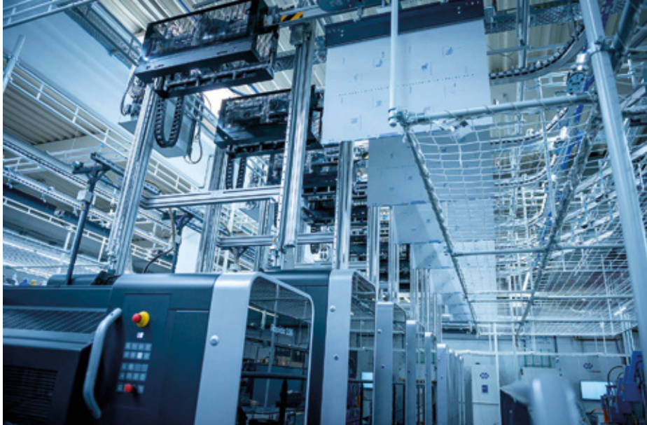
NOVINKA: logistika desek PlateTronic až po šachtu měniče desek. Od osvitové jednotky přes zásobník desek až po měnič desek probíhají všechny procesy plně automaticky
