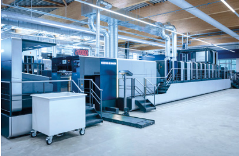
Pro výrobu obalů zvýšený stroj Rapida 106 X se sedmi tiskovými jednotkami, dvojitým lakováním, další tiskovou jednotkou za první lakovací věží a zařízením na nanášení fólie za studena FoilTronic
