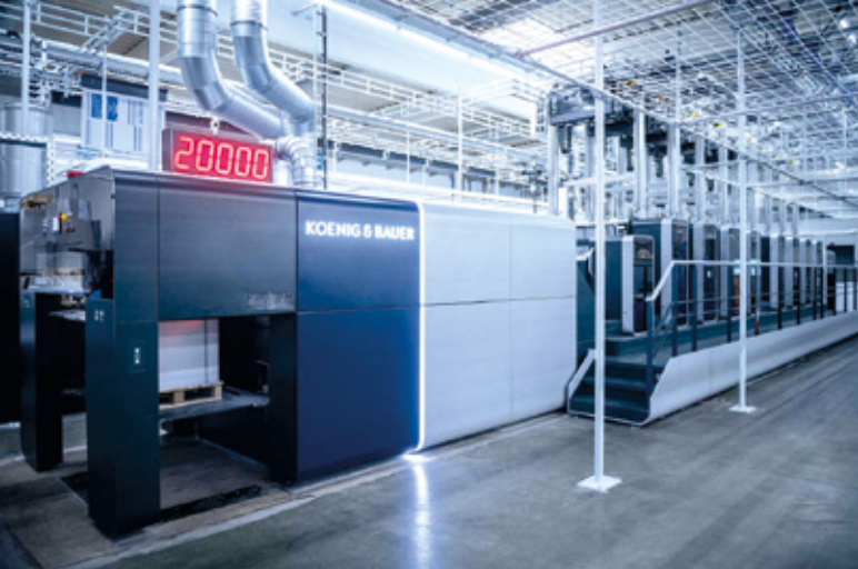
Typický akcidenční stroj: Rapida 106 X jako osmibarvový stroj s obracenním archů pro tisk 4/4 a dodatečnou lakovací jednotkou
