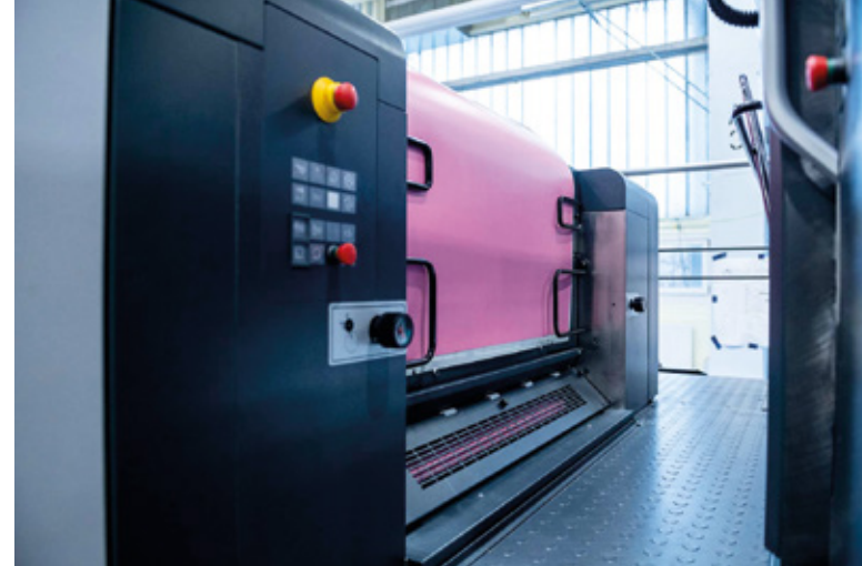
Výměna lakovacích desek je na stroji Rapida 106 X rovněž automatická a díky SAPC provedená bez použití nástrojů do dvou minut.
