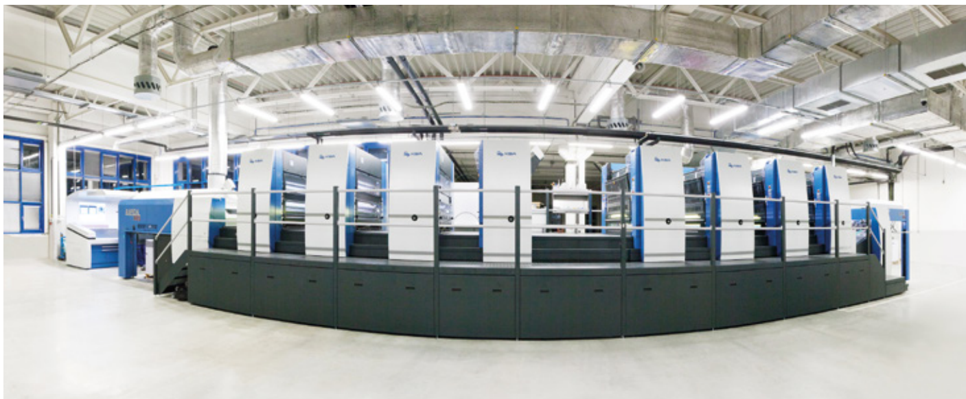
Vysoce automatizovaný osmibarvový stroj s obracením Rapida 145 je nový klíčový stroj akcidenční produkce v Neografii.
