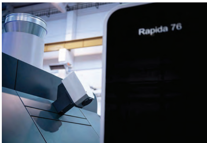
Jeden kamerový systém až pro tři aplikace: regulace vybarvení, inspekce archů a porovnání s PDF.
