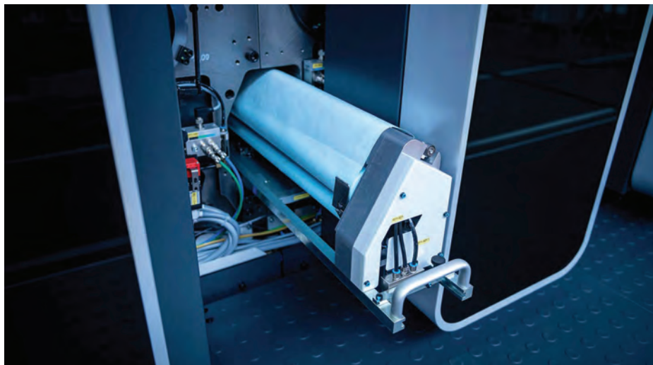
Kromě mytí ofsetových potahů disponuje Rapida 76 také dobře přístupným zařízením na mytí tlakových cylindrů.
