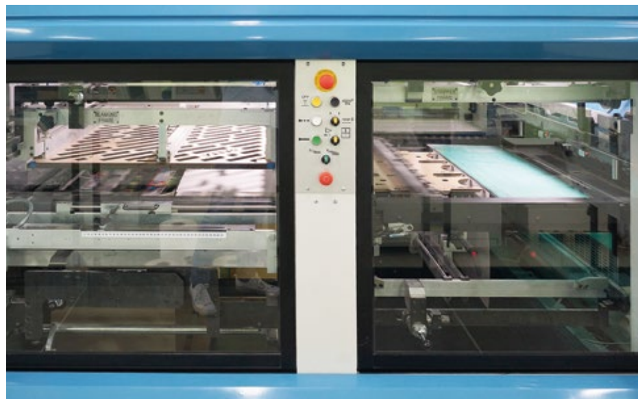
Stroj Optima 106 K dodaný firmě RD má velmi bohaté vybavení, například rám pro vylupování a rozlamování.
