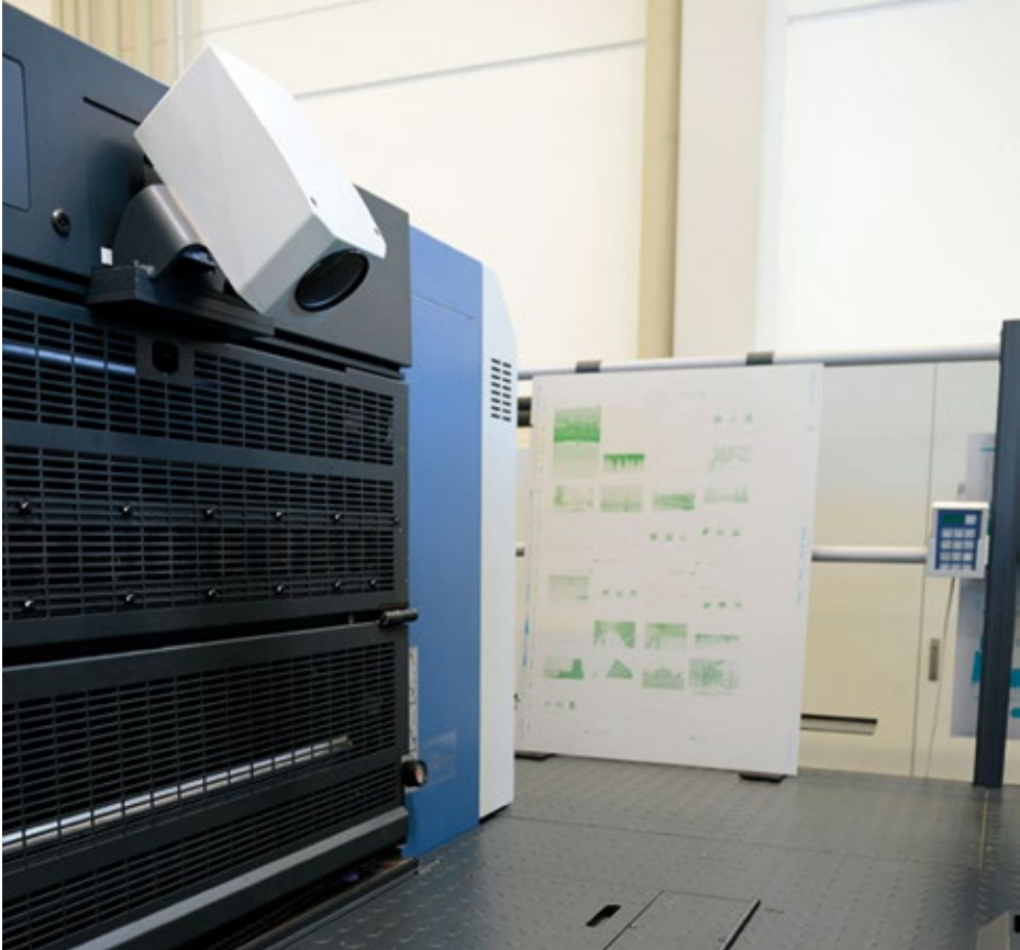
Na první pohled se kamery systému QualiTronic NextGeneration neliší od dosavadních. Novinkou je kromě měření vybarvení a kontroly archů i možná kontrola podle PDF.
