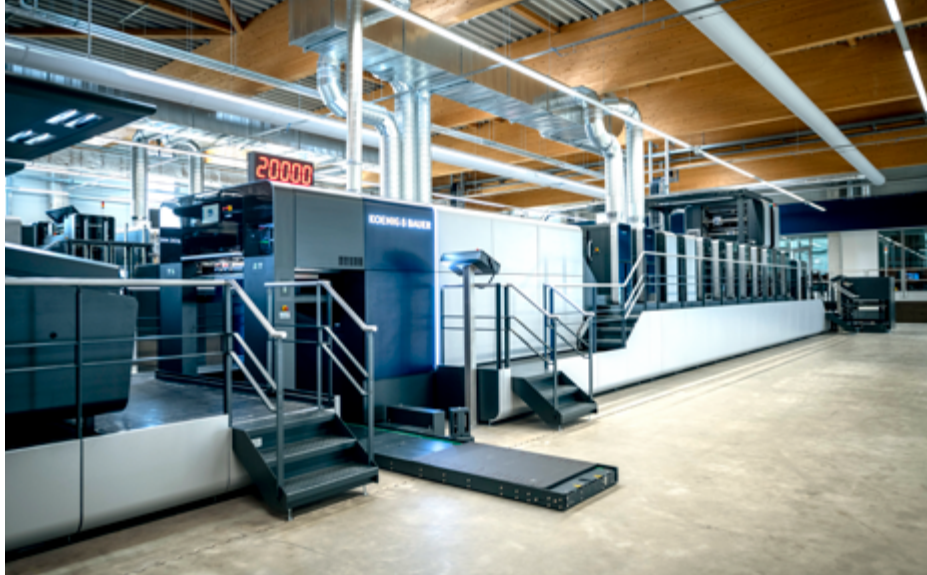
Rapida 106 X s maximálními možnostmi inline zušlechťování – včetně dvojitého lakování, tiskové jednotky za první lakovací věží a nanášením fólie za studena.
