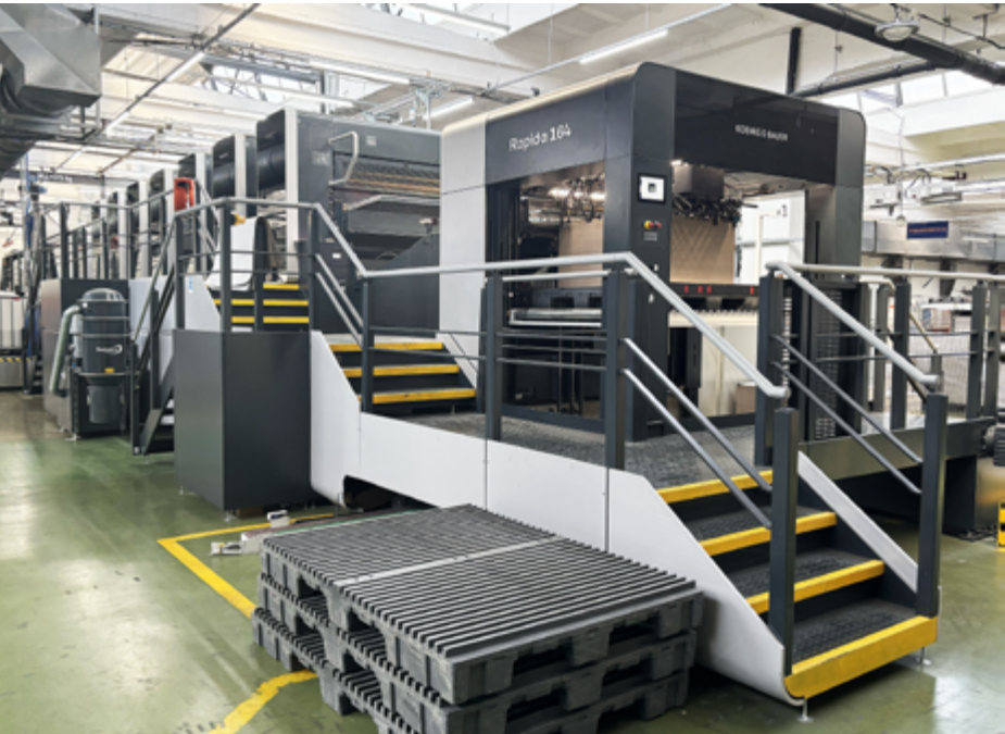
Stroj Rapida 164-7-LTTL ALV3 se sedmi tiskovými a dvěma lakovacími jednotkami v DS Smith v polských Kielcích.
