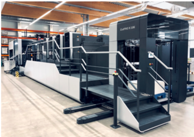
Ražba, rilování, výsek, výlup a rozlam v jednom stroji: Rotační výsekový stroj CutPRO X 106 produkuje s výkonem až 16 000 archů/h.
