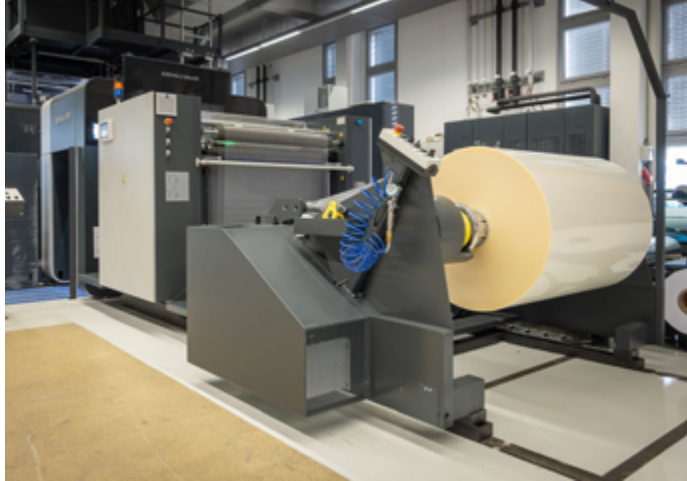
Nakladač z role RS 106 X v provozu s IML fólií
