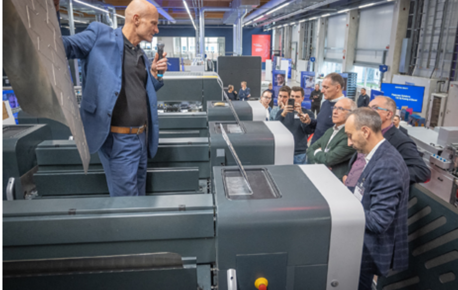
S rychlostí vysekávání až 16 000 archů/h je rotační výsekový stroj CutPRO X 106-3 SB opravdový Game Changer ve výrobě skládaných krabic. Dirk Winkler představil výsekové nástroje, procesní jednotky a používaný výrobní proces.
