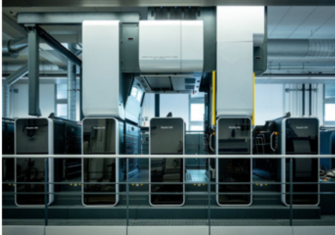
Modul pro nanášení fólie za studena FoilTronic optimalizuje spotřebu fólie – s funkcí MFU a indexováním.
