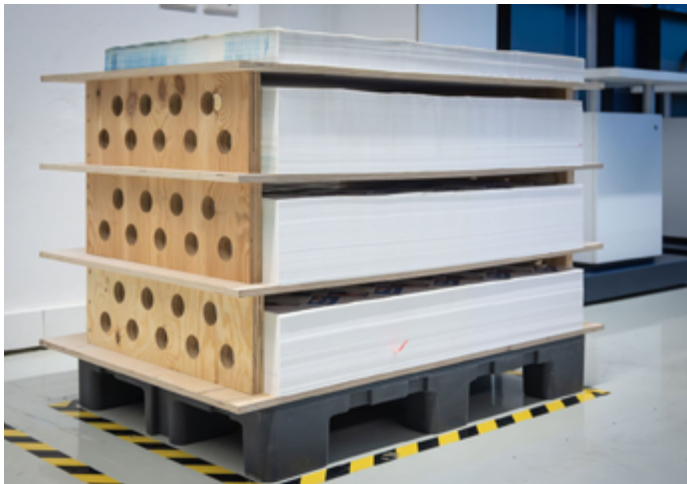
Vykladač vytvářející štůsky zlepšuje tvorbu stohu při tisku na IML fólii a podobné substráty.
