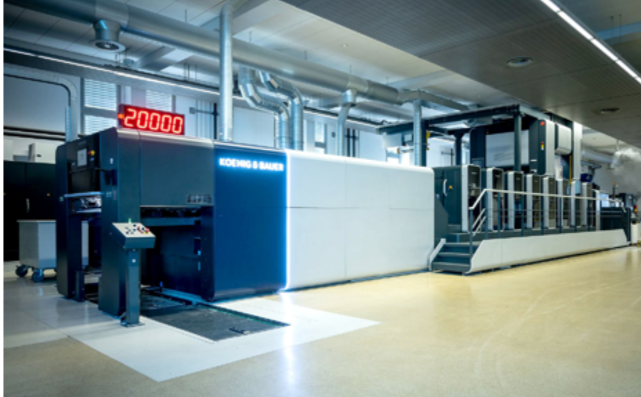
Rapida 106 X v typické konfiguraci pro výrobu etiket: nakladač z role RS 106 X, sedm tiskových jednotek, modul pro nanášení fólie, inline lakovací jednotka s AniloxLoader a prodloužený vykladač.
