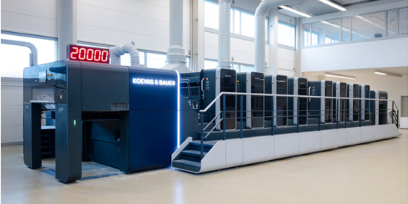
Typický akcidenční tiskový stroj: Rapida 106 X s osmi tiskovými jednotkami a obracením pro produkci 4/4 produkuje rychlostí až 20 000 archů/h i v režimu obracení.
