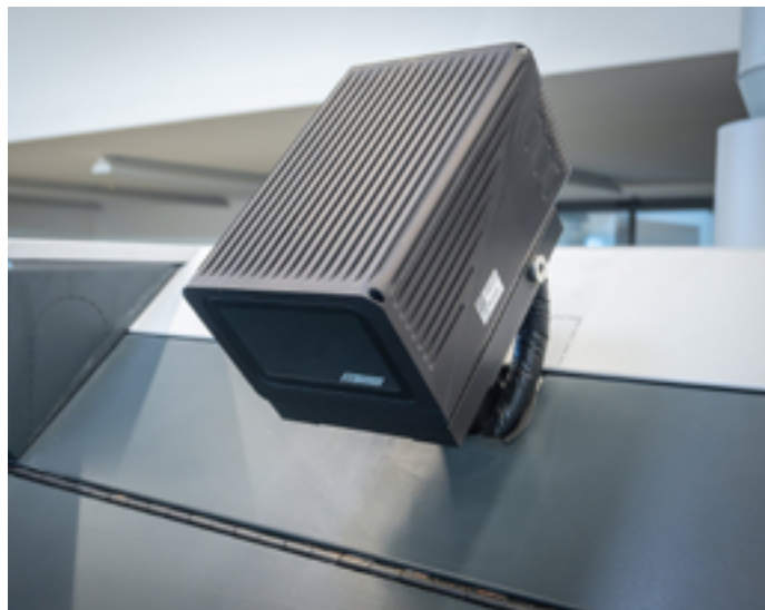
Inline regulaci vybarvení a kontrolu obsahu každého archu umožňují nejmodernější kamerové systémy i při maximální rychlosti produkce 22 000 archů/h.
