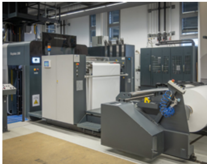
Archový ofsetový tisk s rolovým materiálem: Archovací zařízení RS 106 zajišťuje přesné podávání tiskových materiálů do nakladače.
