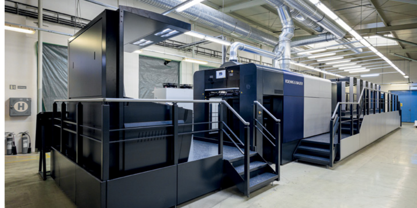
Nejmodernější verze Rapida 105 v konfiguraci se šesti konvenčními tiskovými a jednou hybridní lakovací jednotkou.
