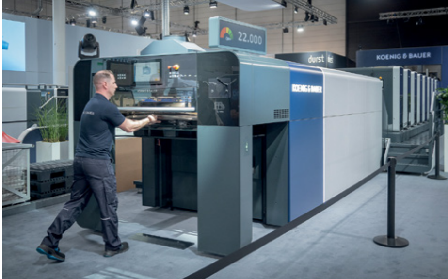
S rychlostí tisku až 22 000 archů/h je Rapida 106 X nejrychlejším archovým ofsetovým strojem na světě.
