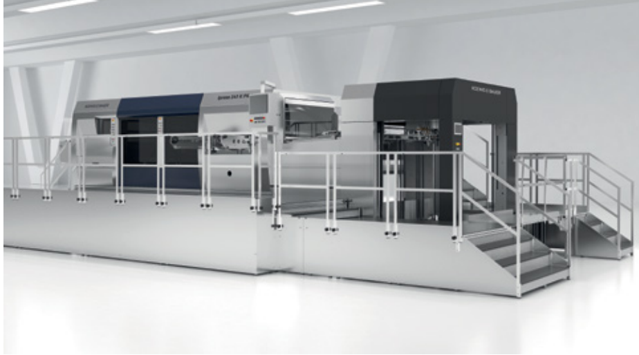
Nejmodernější plochý výsekový automat Ipress 145 K PRO z dílny Koenig & Bauer Iberica.
