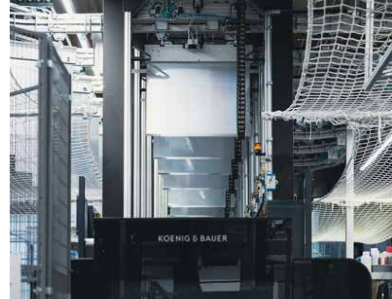
Spouštění tiskových desek přímo do vstupní šachty měniče desek jednotlivých tiskových jednotek.
