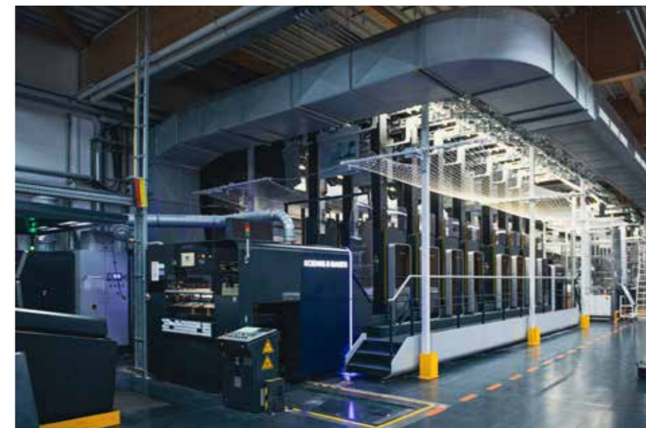
Stále více archových ofsetových strojů, jako je tato osmibarevková Rapida 106 X s obracacím zařízením 4/4, je integrováno do modulárních systémů logistiky desek.
