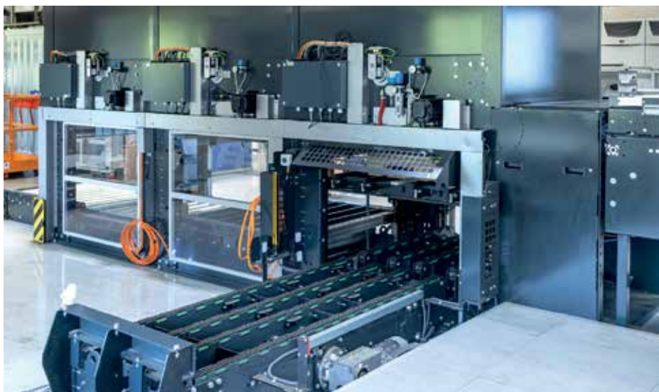
Stohovací boxy trojitého stohovače lze využít jak na makulaturu, tak na stohování dobrých archů.
