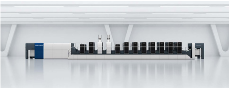
2 Tiskové věže za lakováním umožňují mj. přesné a nákladově efektivní efekty s matným lakem.
