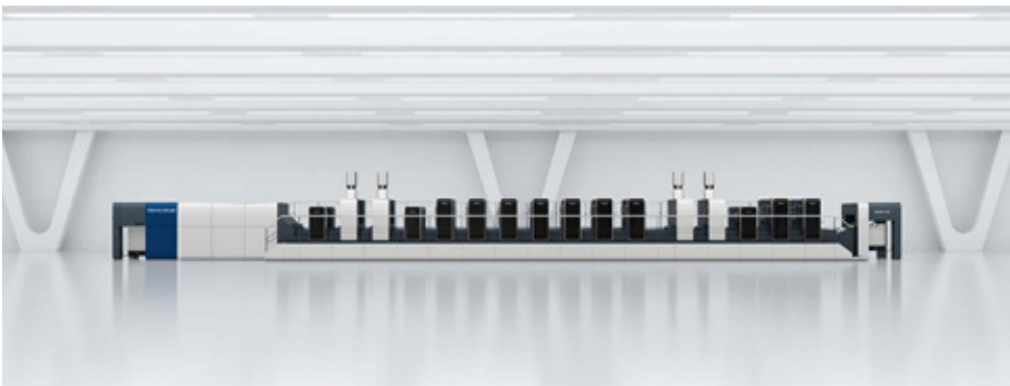
3 Stroje s obracením s tiskovými a lakovacími věžemi před a za obracecím zařízením zušlechťují skládanou krabičku a zvyšují její viditelnost v místě prodeje.
