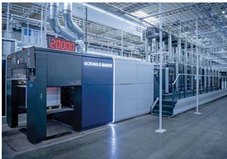
Osmibarvový stroj Rapida 106 X s obracením pro produkci 4/4 a přídatnou lakovací věží je novým srdcem v tiskové hale Krüger Druck+Verlag.
