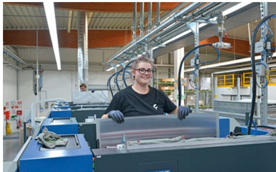
Příprava tisku: Karl-Josef Christ a asistentka Sofie Hetzerová společně osazují osm výměnných šachet tiskovými deskami pro následující zakázku
