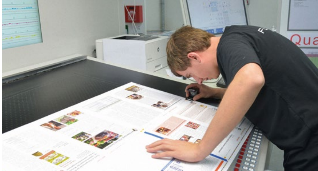
I přes všechnu automatizaci: tiskař Karl-Josef Christ kontroluje soutisk před spuštěním nové zakázky.
