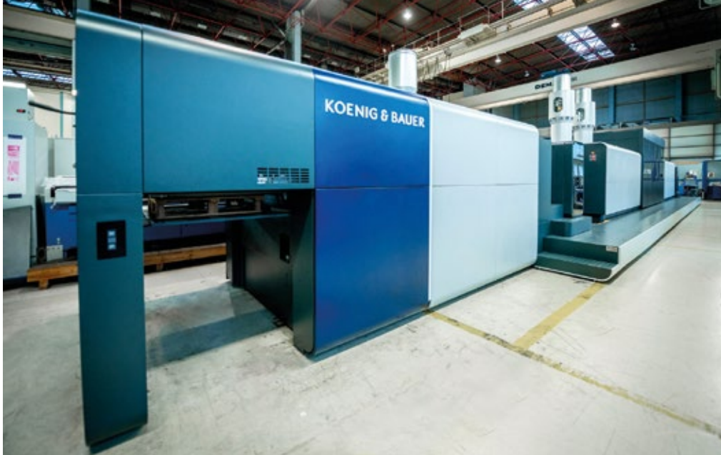
Modulární koncepce strojů VariJET umožňuje při potisku skládaných krabiček kombinaci digitálního inkoustového tisku s možnostmi tisku a inline zušlechťování známými z ofsetového tisku
