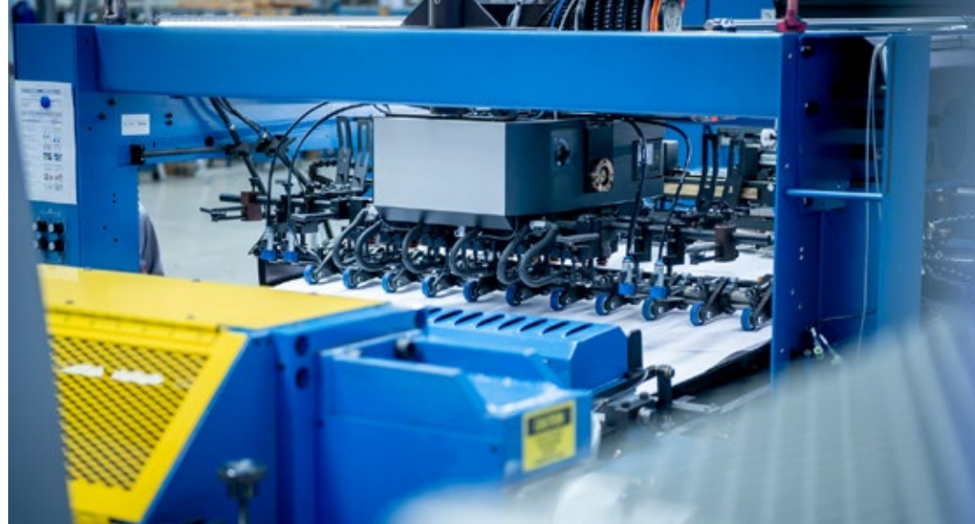
Zařízení pro řezání materiálu kotouč-arch v plné akci při maximálním výkonu stroje 15 000 archů/h
