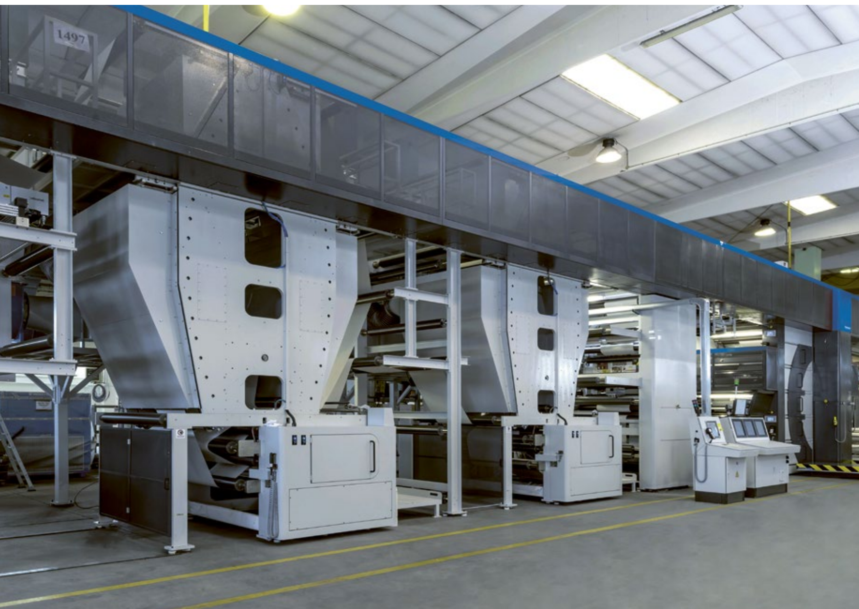
Pohled na flexotiskové jednotky, postavené v řadě za sebou.
