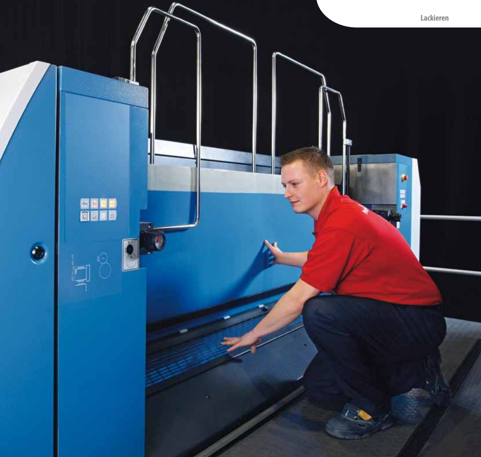
Der Lackplattenwechsel ist dank Automatisierung in kürzester Zeit möglich
