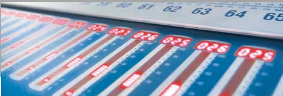
Farbprofileinstellungen über die Zonenverstellung am Leitstand
