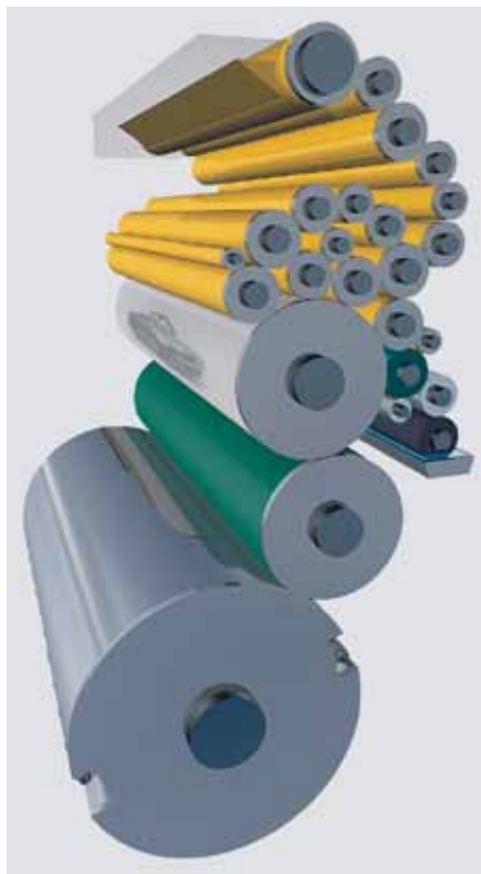
Schematische Darstellung des Farbwerkes
