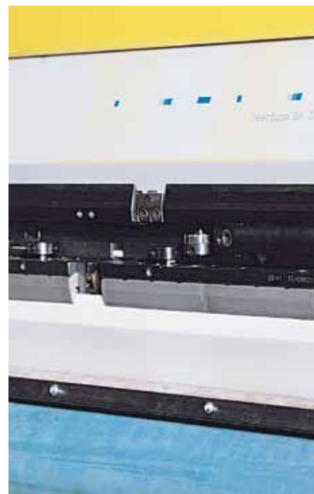
Geteilte Plattenspannschienen erleichtern evtl. erforderliche Passerkorrekturen
