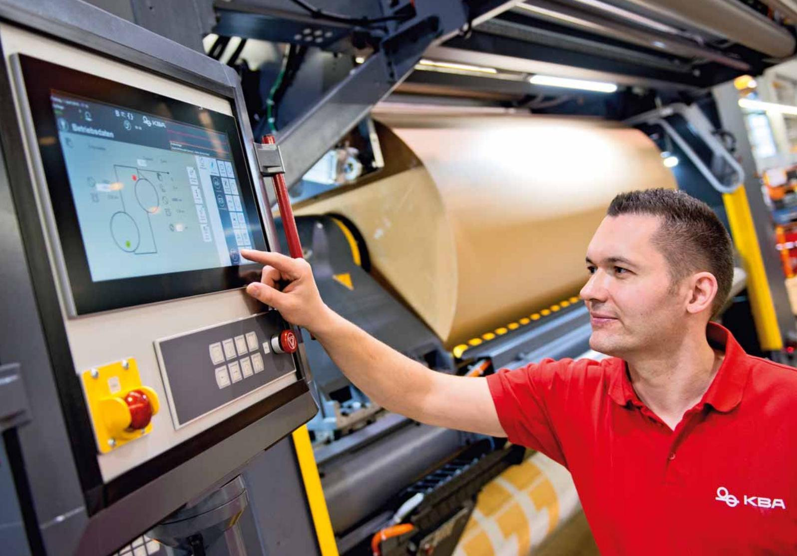
Der Hochleistungs-Rollenwechsler KBA Pastomat CL ermöglicht im Digitaldruck neue Breitendimensionen bis 2,80 m
