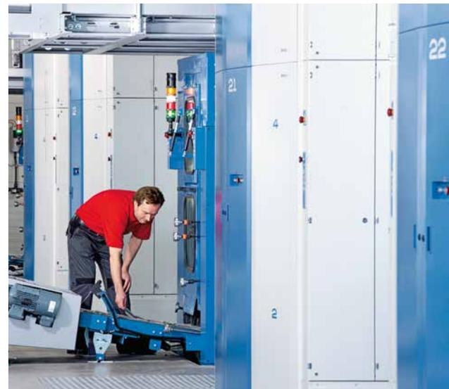
Das Hochleistungs-Klappenfalzwerk KF 5 wird bei der Commander CT häufig eingesetzt
