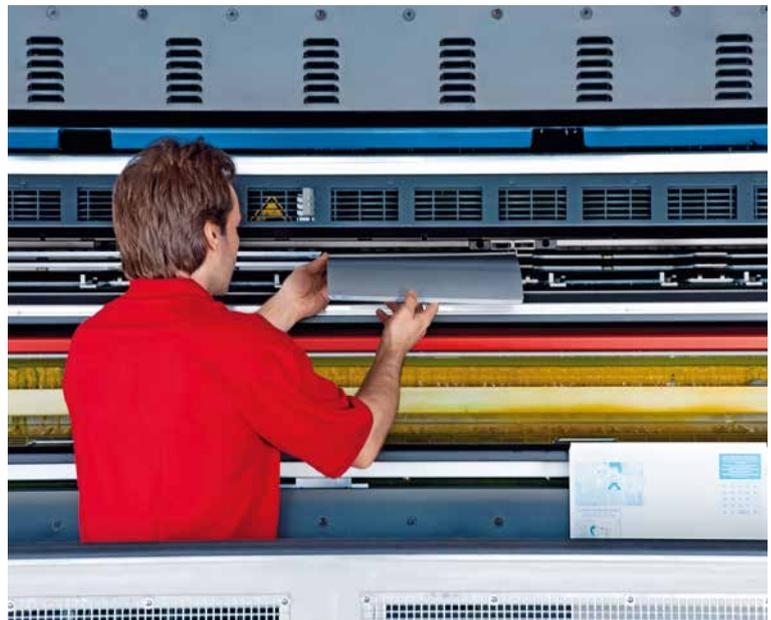
**Der praxisorientierte PlateTronic-Plattenwechselvollautomat ermöglicht schnelle Jobwechsel und die Plattenbestückung bzw. -entsorgung bei laufender Produktion: Er kommt auch bei der Cortina zum Einsatz**
