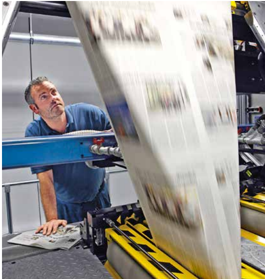
Cortina-Anlage mit Trocknerausstattung für die Heatset-Produktion ohne Farbwechsel im Eco Print Center des Medienhauses De Persgroep, Belgien
