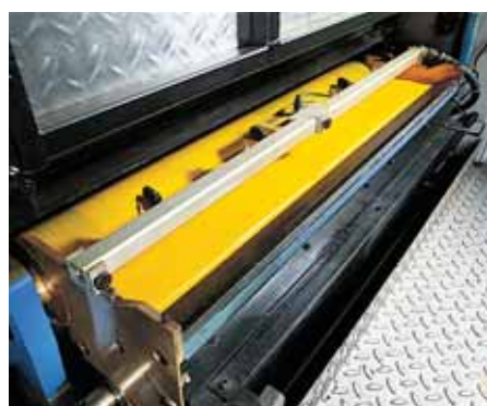
Abschwenkbare Farbkästen für einen schnellen Farbwechsel
