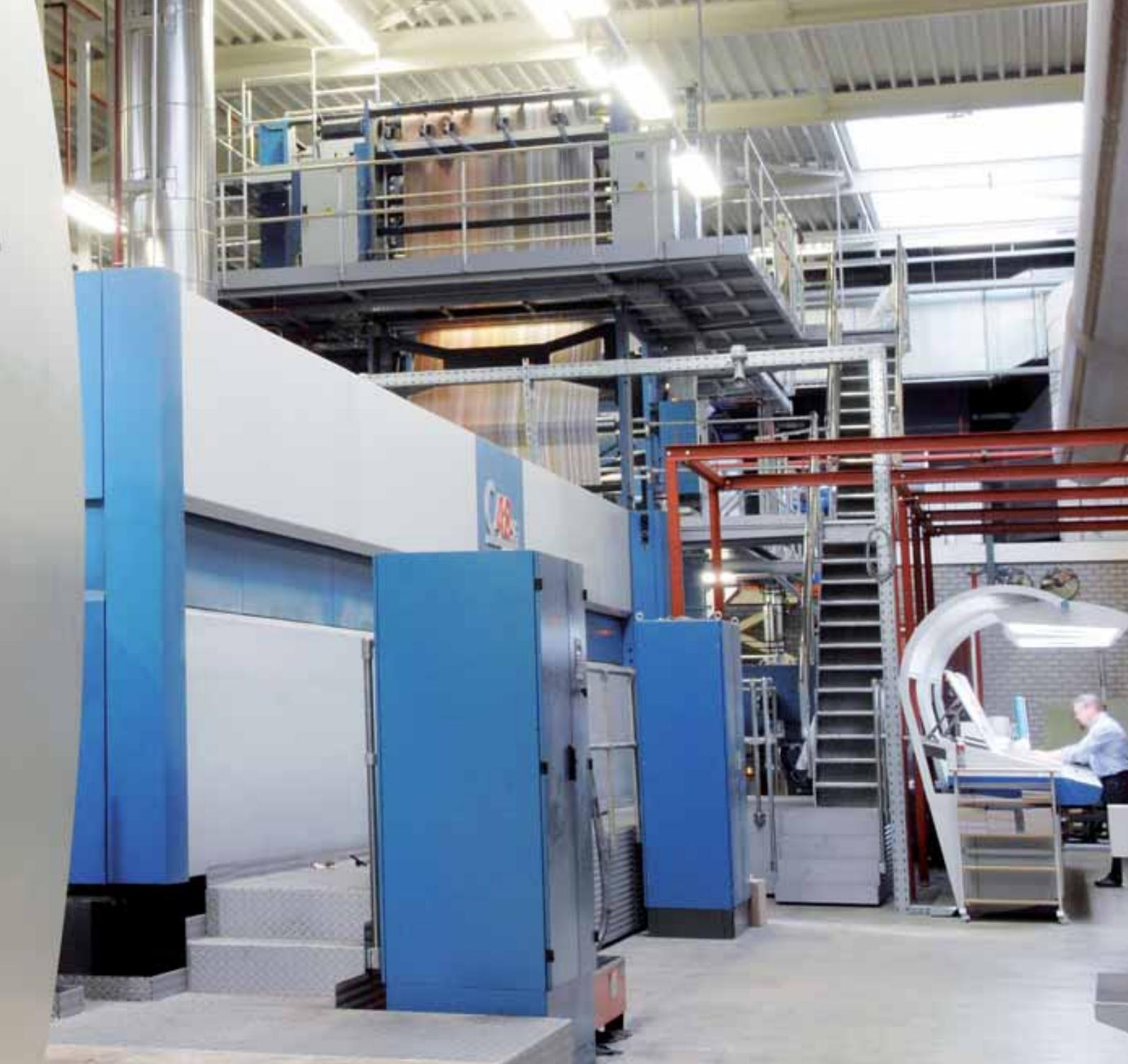
Die C48 SG und C56 SG sind in puncto Automatisierung, Workflow, Bedienerergonomie und Wartungsintensität Rotationen der neuesten Generation. Der automatische Plattenwechsel, die vollautomatische Falzapparatstellung und Alleinstellungsmerkmale wie die automatisierten KBA RollerTronic-Walzenschlösser tragen zu einer enormen Nettoproduktionsleistung bei. Der heute vor allem bei Werbedrucksachen erwarteten Formatflexibilität kommt das Maschinenkonzept mit liegenden Seiten entgegen.
