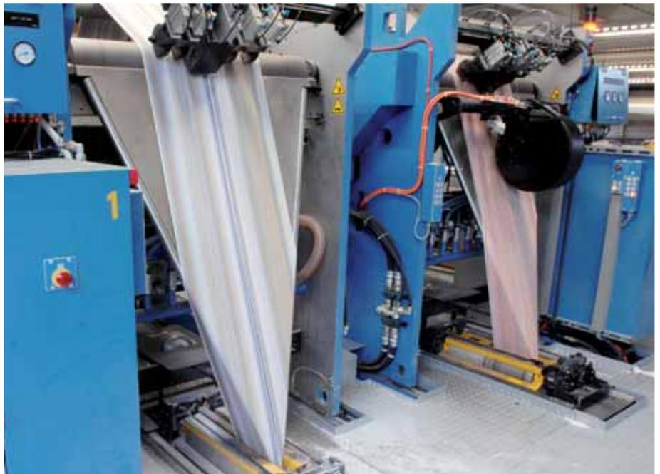
Oben: Skip Slitter-Technologie (rechter Trichter) für noch höhere Produktionsvielfalt
