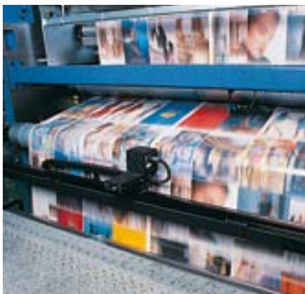
Farbmess- und -regelungen für beste Druckergebnisse
