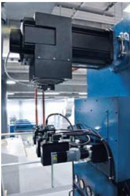
Einzelantriebstechnik vom Rollenwechsler über die Druckeinheiten, Überbau bis hin zum Falzapparat
