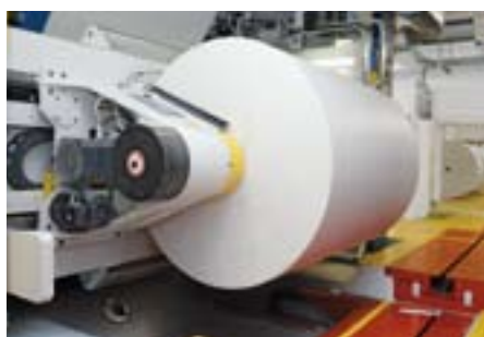
Antrieb der Papierrollen im Rollenzentrum mit robusten AC-Motoren
